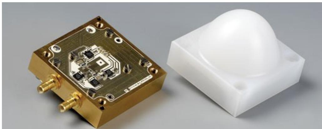
**Figure 2.1:** A mmWave GaAs hybrid [28].
